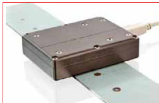
Obr. 2 Kontrola bodového svaru pomocí MagCam
